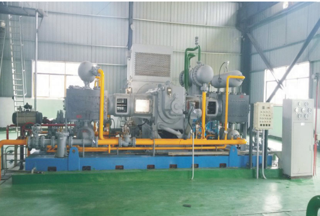
MW-2.1/18-201-6.0/12-201 型高压流程液化天然气压缩机 MW-2.1/18-201-6.0/12-201 High Pressure Process Liquefied Natural Gas Compressor
