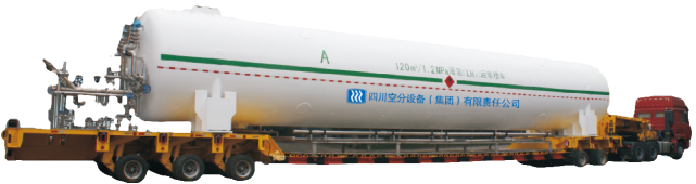
120m 3 液氢运输车 120m 3 Liquid Hydrogen Tanker
